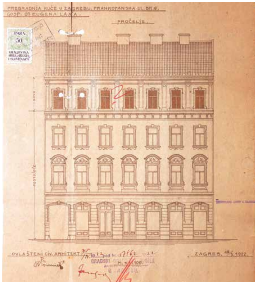
Projekt dogradnje trećeg kata, 1922., pročelje (neizvedeno), DAZ
