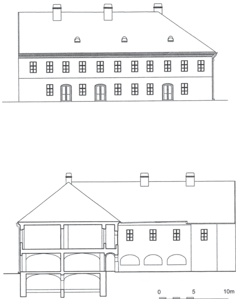
3. Palača Pejačević, presjek i istočno pročelje (arhitektonska snimka: Atelier X, grafička obrada Ivana Valjato-Vrus)
